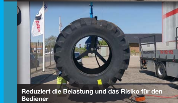
Einfache vertikale Drehung um 360° mit der Hand
