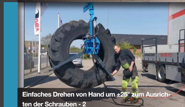
Einfaches Drehen von Hand um \pm 25^\circ zum Ausrichten der Schrauben - 1
